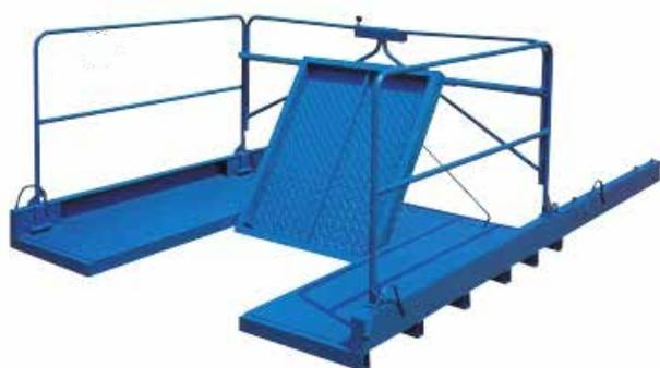
Plataforma de carga y descarga modelo **CON TRAMPILLA**. Esta Plataforma lleva una trampilla abatible, lo que permite su instalación en configuración vertical. La trampilla abatible sirve para el paso del cable de la grúa. Se deben utilizar dejando todas las trampillas levantadas y bajando únicamente la correspondiente a la planta en donde se va a utilizar.
